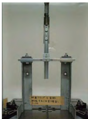
耐震補強クリップS背掛 (N-38背)試験状況
