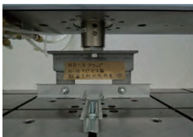
ND-Sクリップ試験状況
