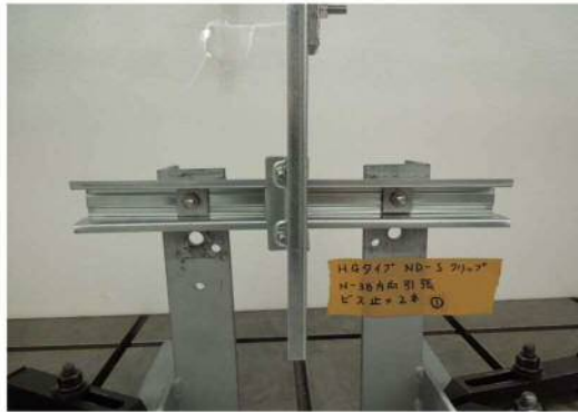
ND-Sクリップ試験状況
