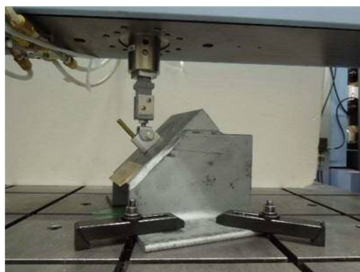
【ブレース上端接合部の試験】
