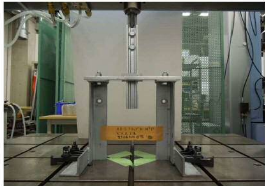
ND-Sクリップ試験状況
