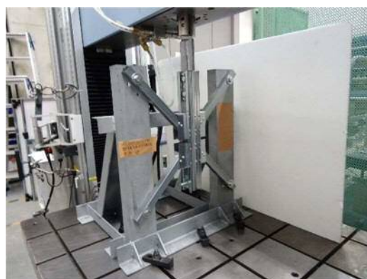
【ブレース下端接合部の試験】
