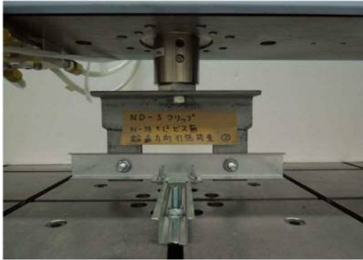
ND-Sクリップ試験状況
