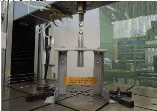
ND-Sクリップ試験状況
